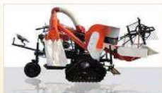
Mesin panen dilengkapi dengan roda crawler karet dan memiliki kapasitas 2 sak karung
